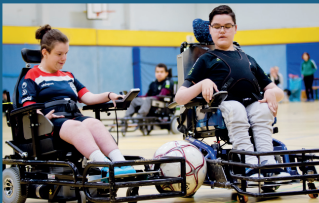
Mit Metall-Schussgittern werden Alltagsrollstühle zu PCF Sportrollstühlen umgerüstet.
